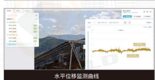
设备自运行以来，监测数据平稳，竖向位移和水平位移值均在±2mm以内，柔性支架结构整体处于稳定状态。
